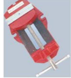
Şekil-2 Paralel Ağızlı Makine Mengenesi
