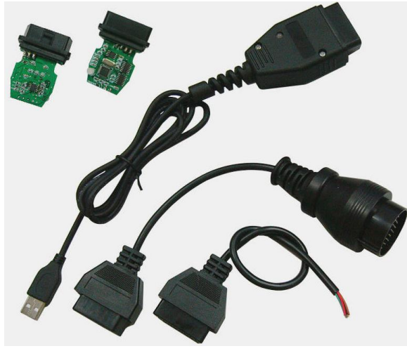
Resim -10 Diyanostik cihazında kullanılan kablo ve soketler
