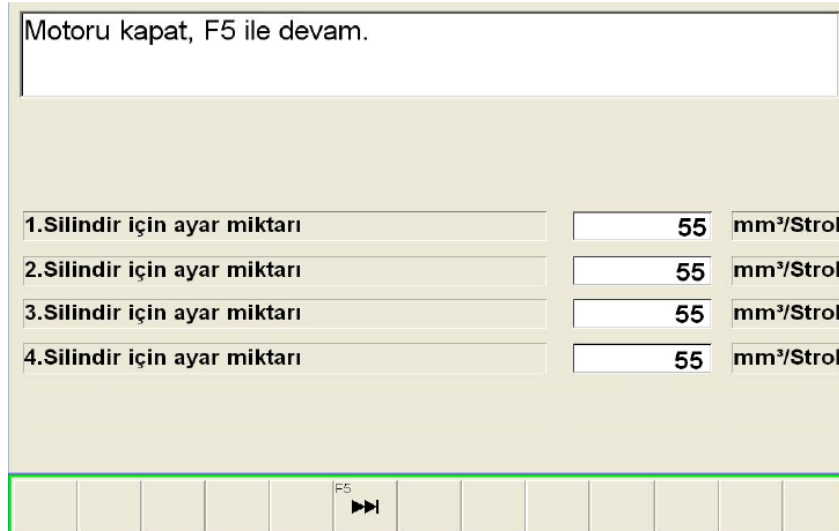
Resim 26: Diagnostik cihazı ile enjektör püskürtme oranlarının incelenmesi
