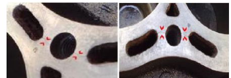
Silindir kapak Metal çatlaklığı
